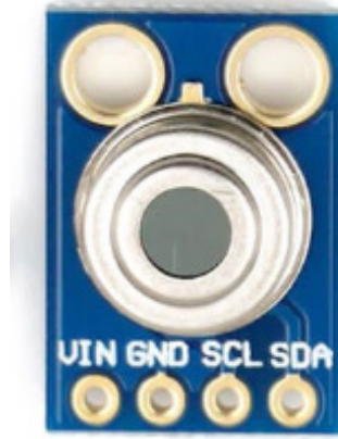
Şekil 8.8. MLX90614 Temassız Kızılötesi Sıcaklık Sensörü
